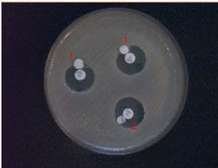
Figuur 2. AmpC disk test: blanco schijfje geïmpregneerd met EDTA naast cefoxitin (FOX). Indeuking wijst op een ampC β-lactamase (zie tekst voor beschrijving). (1: K. pneumoniae ampC Pos stam; 2: negatieve controle)
